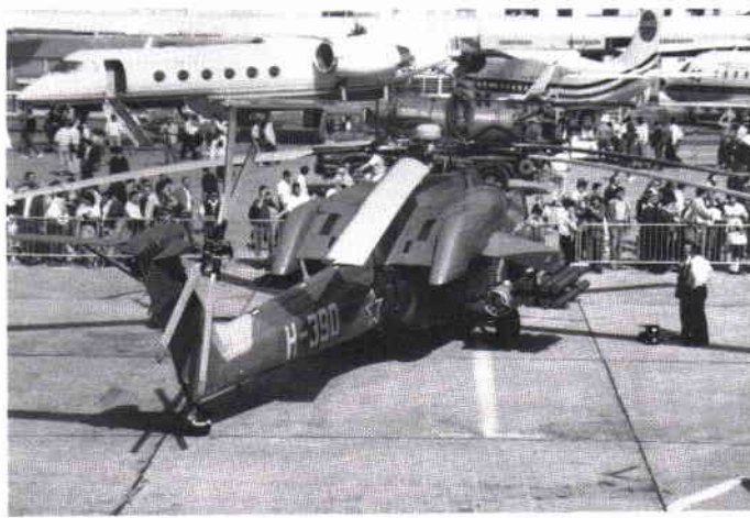
Mi-28 – utrustad med två turboaxelmotorer typ Isotov TV3-117.
